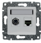
Gniazdo TV pojedyncze typ F + Gniazdo komputerowe żeńskie typ F - żeńskie typ F + RJ45, kat. 5E, nieekranowane Single TV socket + computer single socket non-shielded
